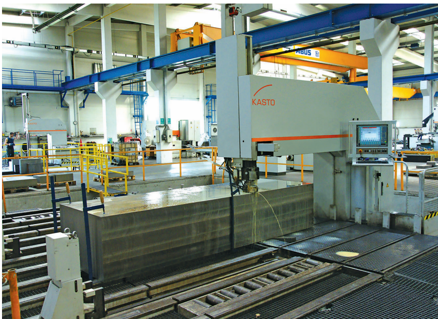
1 Der Bau- und Werkzeugstahl-Spezialist JKZ Bučovice setzt zum Bearbeiten großer und schwerer Werkstücke auf zwei vollautomatische Blockbandsägemaschinen vom Typ Kasto bbs A 3x20 © Kasto
